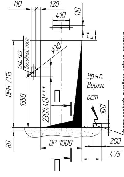
Место подвода силового кабеля, пожарно-охранной сигнализации и диспетчерской связи, заземления кабеля для освещения шахты (см таблицу 1). Свободный конец не менее 1м
