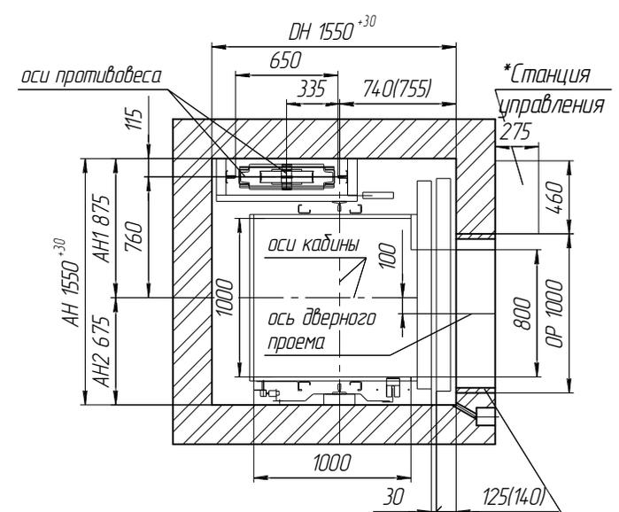
Строительное примыкание. Обеспечивается заказчиком после монтажа дверей шахты.
